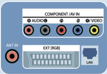
↑ Разъем для подключения антенны на цифровом телевизоре
